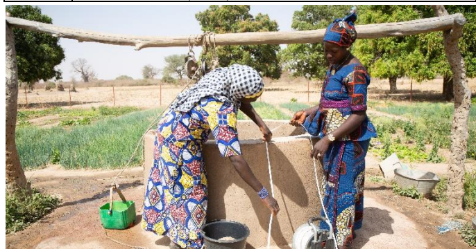
Imagen 7: Fatimata Coulibaly y Awa Dembélé, ambas miembros del grupo de mujeres Benkadí, usando una sonda eléctrica para medir el nivel del agua dentro de un pozo en el interior de una huerta, Kakounousou, Samabogo, Círculo de Bla, Región de Segou, Malí, febrero de 2019. (© WaterAid / Basile Ouedraogo)
